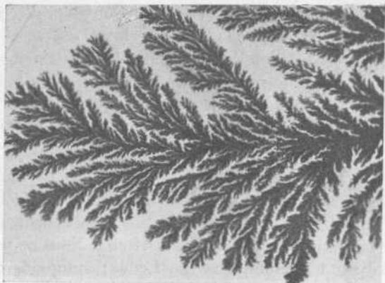
Fig. 26. — Crystallisation de chlorure d'ammonium dans la gélatine (S. Leduc.)
