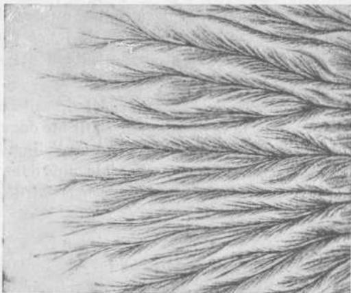
Fig. 27. — Microphotographie d'une étincelle électrique (S. Leduc.)
