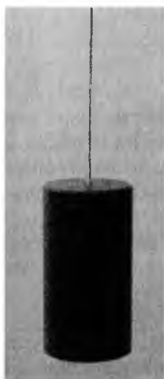
Pendule cylindrique en bakélite pour recherches spéciales
